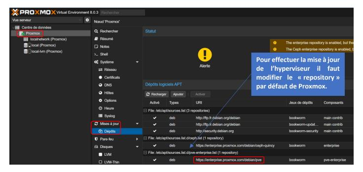
Par défaut, le repository « pve-enterprise » est configuré mais il ne vous permet pas d'accéder aux mises à jour puisque nous n'avons pas de support payant. Il est nécessaire d'ajouter le repository « no-subscription » (ce dernier n'est pas conseillé par Proxmox en production et un message d'alerte s'affichera mais cela ne pose pas de problème d'utiliser ce repository).
