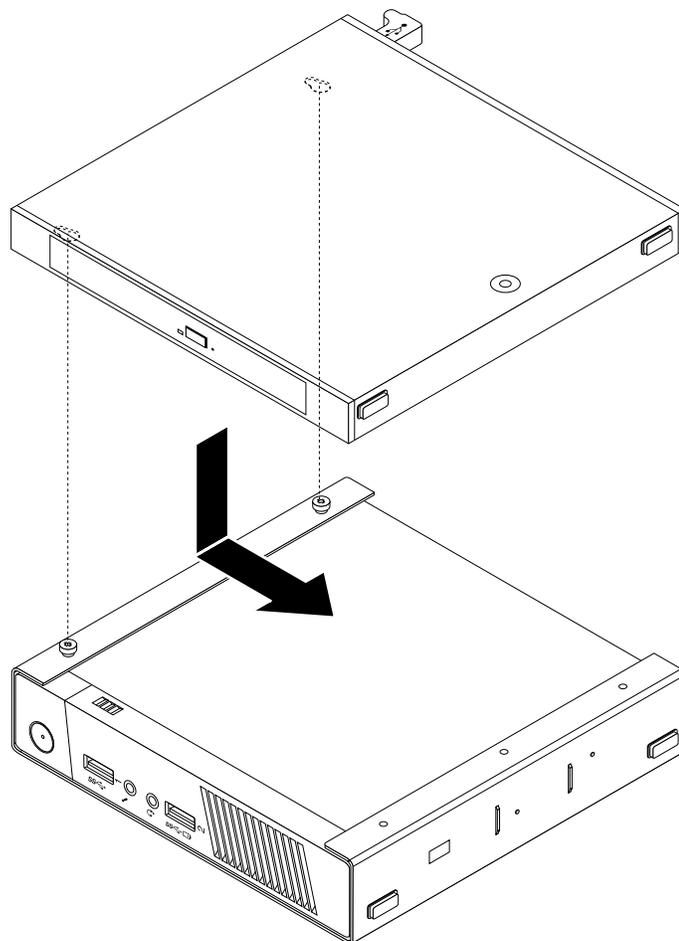
Figure 33. Installation du coffret du disque optique
