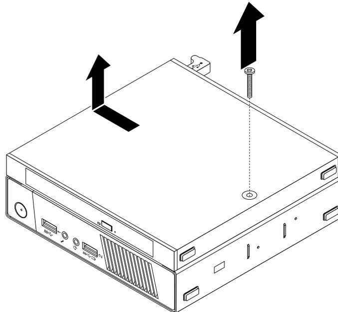
Figure 25. Retrait du coffret du disque optique
