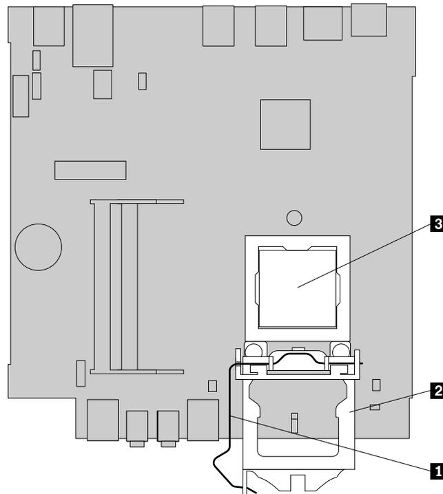
Figure 70. Accès au microprocesseur
