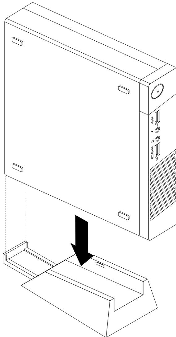
*Figure 9. Installation du socle vertical*
