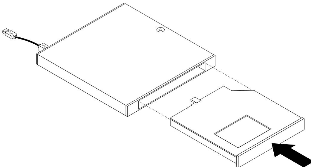
Figure 32. Installation du système de retenue dans le coffret du disque optique
