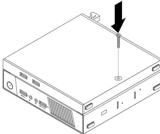
Figure 37. Installation de la vis de fixation du boîtier d'E-S
