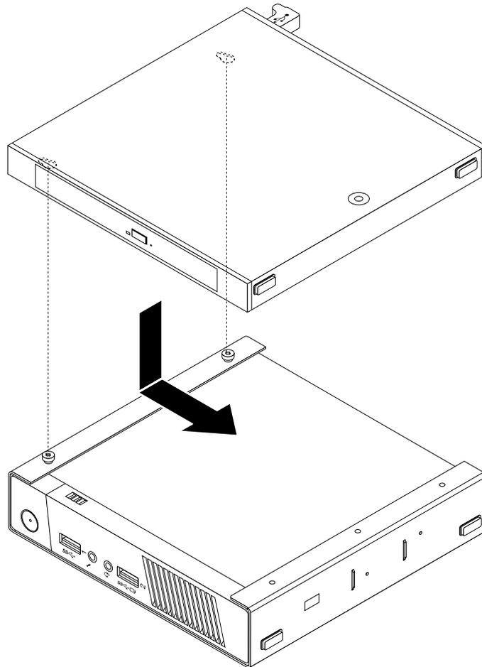
Figure 23. Installation du coffret du disque optique
