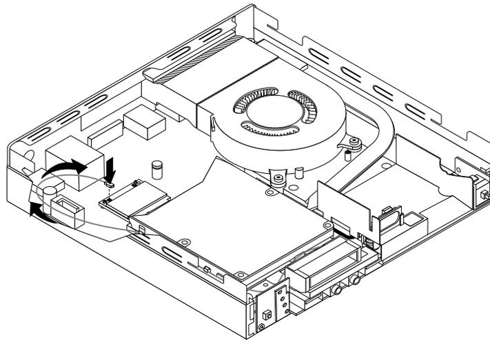
Figure 56. Installation du câble de l'antenne Wi-Fi avant
