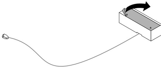
Figure 53. Retrait du papier de protection de l'autocollant
