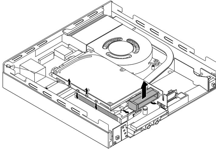
Figure 57. Retrait du câble de l'antenne Wi-Fi avant
