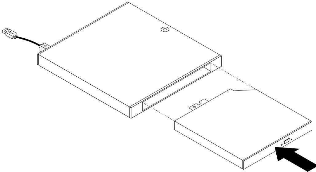
Figure 21. Installation du disque optique dans son coffret
