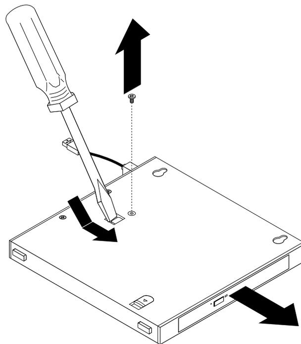
Figure 18. Retrait du disque optique de son coffret
