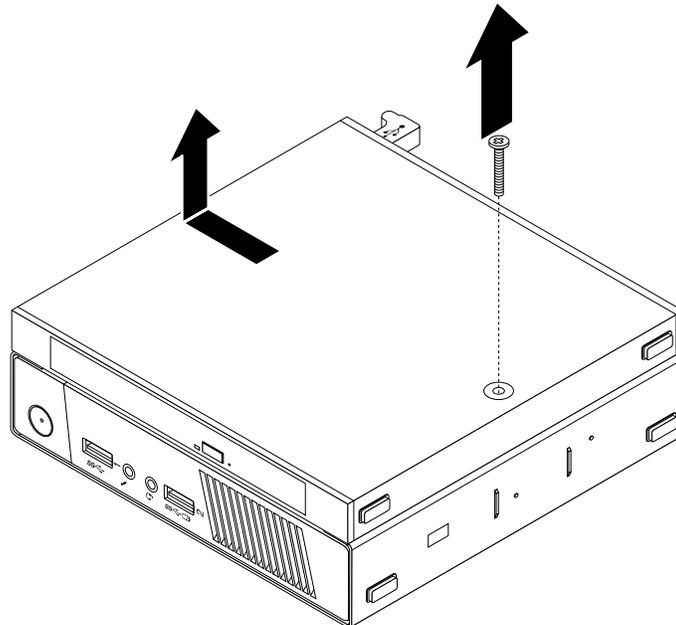
Figure 17. Retrait du coffret du disque optique
