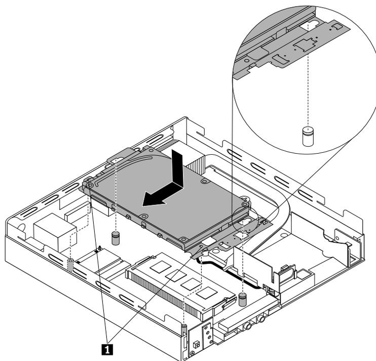
Figure 41. Installation de l'unité de disque dur
