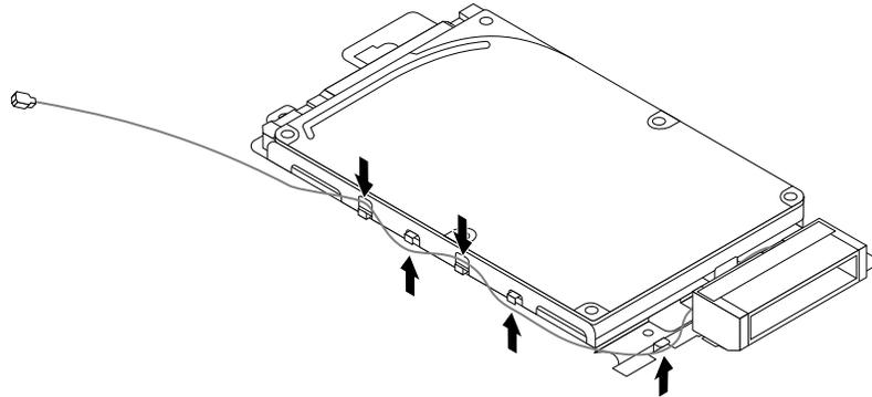
Figure 55. Acheminement du câble de l'antenne Wi-Fi avant
