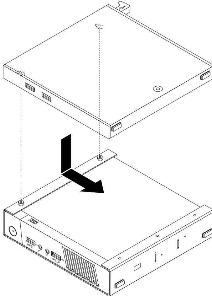
Figure 36. Installation du boîtier d'E-S
